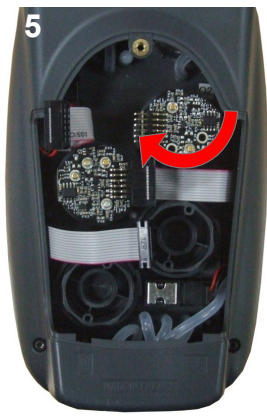
5 Insertion d'une nouvelle cellule puis rotation de la cellule
