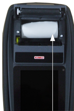
Mise en place du rouleau de papier
