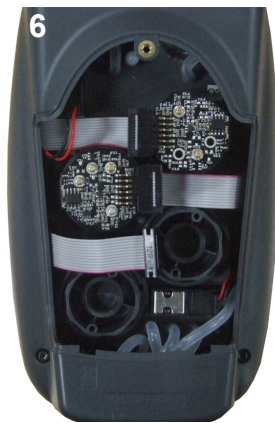
6 Connexion de la nappe et de la cellule
